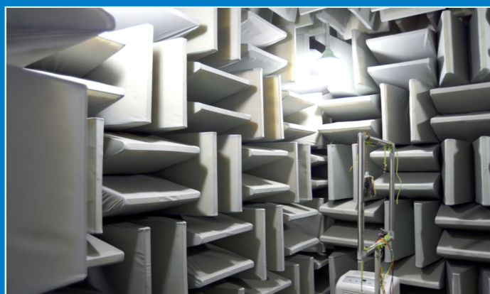
无响室 Anechoic Chamber
